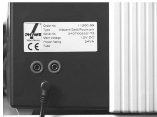
Abb. 4: Buchsen zur Stromversorgung und zum Anschluss des externen Erregers an der Seite des Gehäuses.
