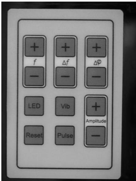
Abb. 3: Bedienfeld bestehend aus 12 Tasten an der Gehäuseoberseite des Wasserwellengeräts.
